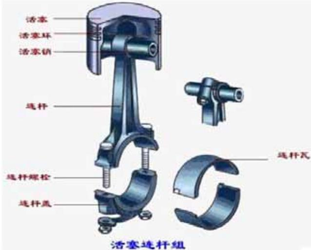
图表15: 气缸套、活塞环、活塞、活塞销示意图
