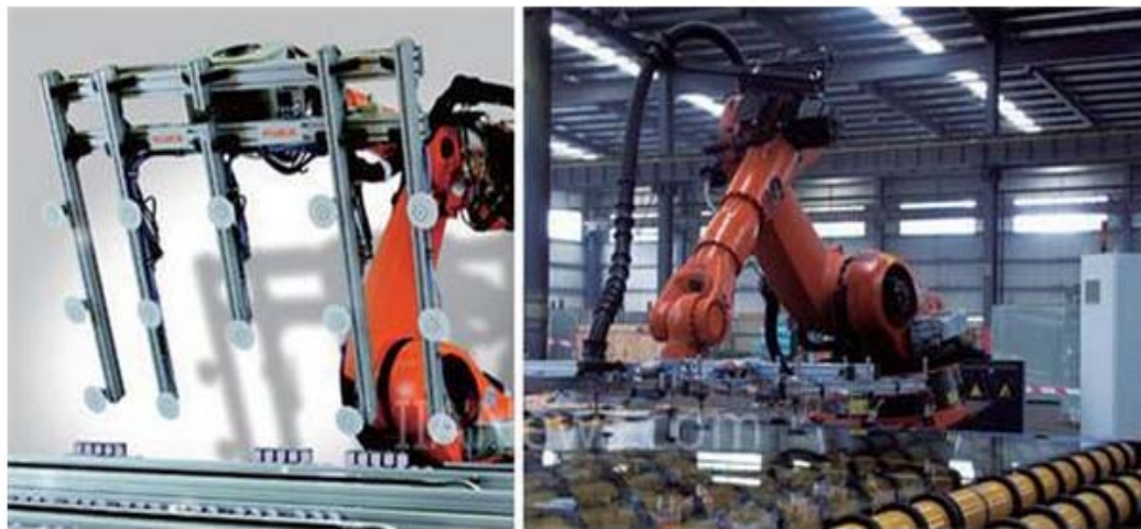
图 6：玻璃生产码垛机器人示意图
