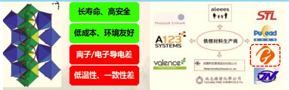
图表7: 磷酸铁锂材料结构、优点 (绿底色)、缺点 (红底色) 及主要供应商
