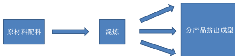
图 2: 混炼胶是公司各产品的原材料
