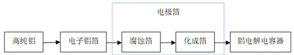
图表 23: 铝电容器生产工艺
