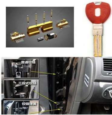
图 26: 公司锆基非晶合金在汽车锁、铰链上的应用
