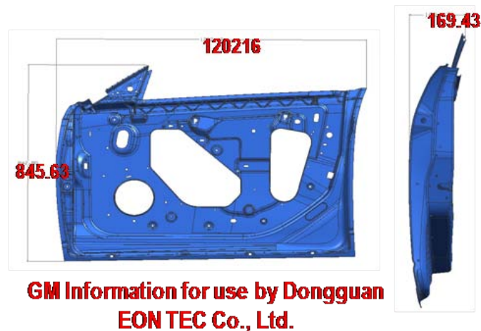
图 40：宜安科技为 GM 研发的镁合金车门示例
