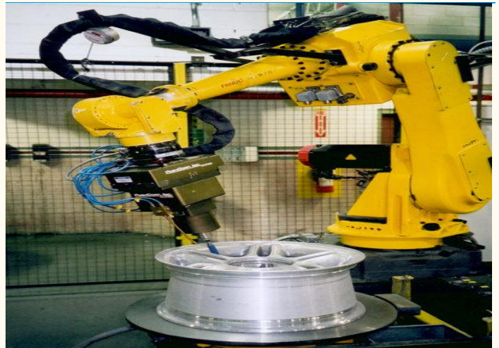
图表 31：机器人打磨轮毂省时省力又标准
