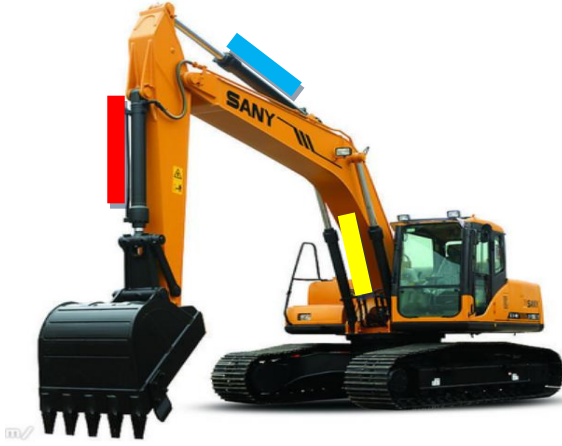
图 6 挖掘机专用油缸示例
