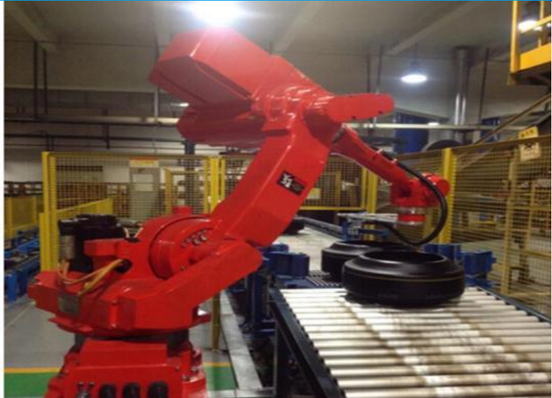
图表 13：公司为中策设计的工业机器人自动化生产线
