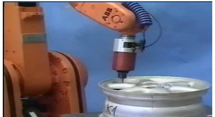
图 43: 机器人打磨可保证产品的高生产率、高质量和高稳定性
