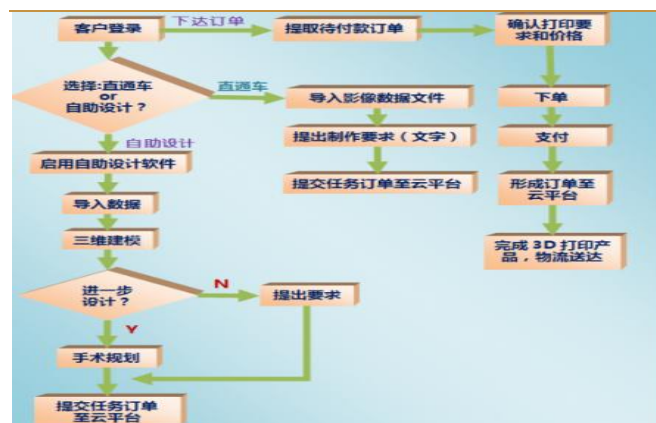
图 10：光韵达数字医疗 3D 打印服务流程
