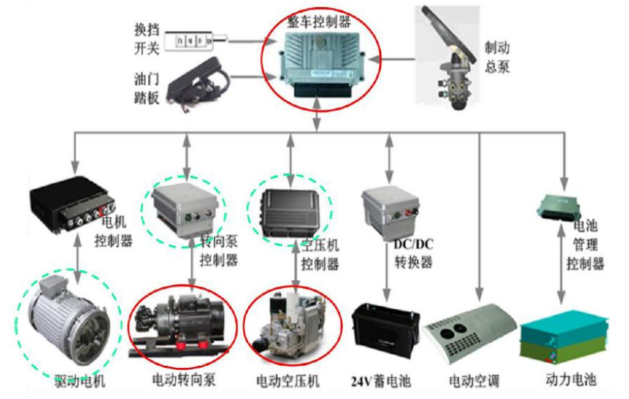
图表 12.上海海能开发的纯电动车控制系统
