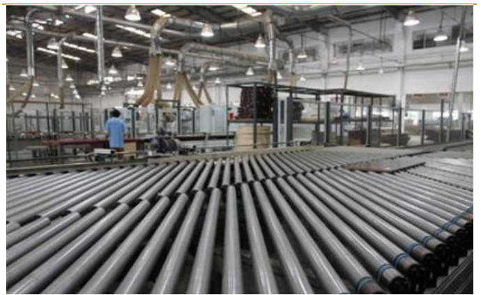
图 12：柔性生产线自动封边：可同时加工不同尺寸和花色的板材
