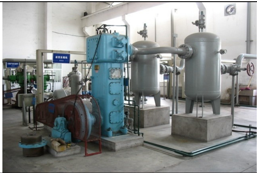
图表 11: 迷宫压缩机及压缩机气量调节系统
