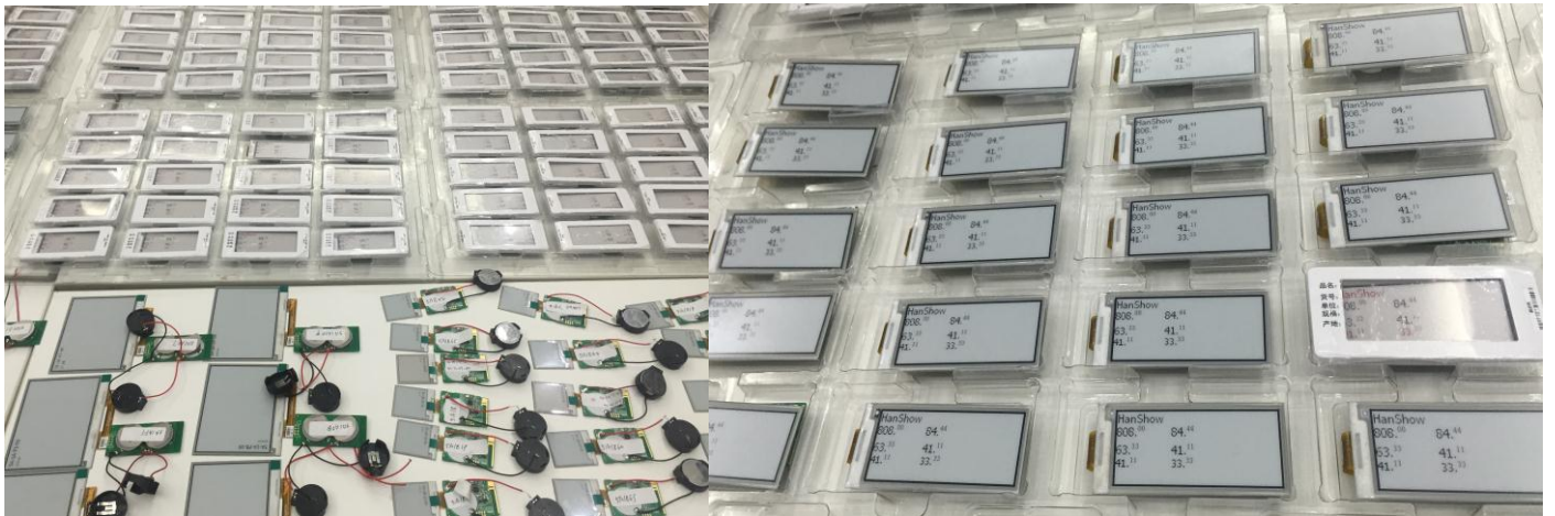
图1 电子纸价签结构简单、易用，仅用一两个纽扣电池即可驱动
