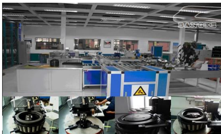
图 5：轴承自动检测检修线
