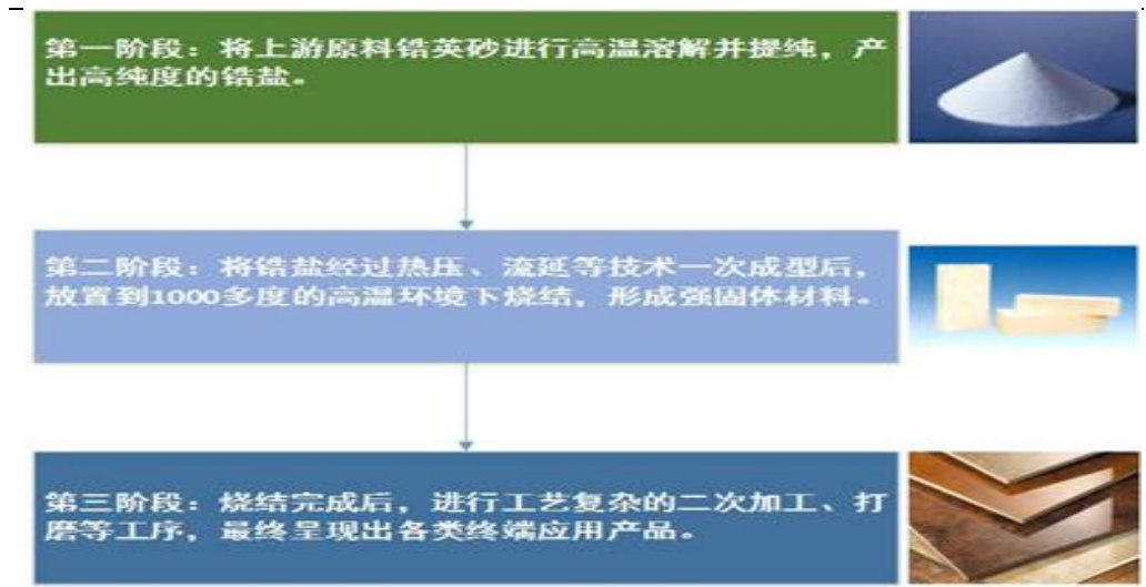
图 3：微晶锆的制备流程
