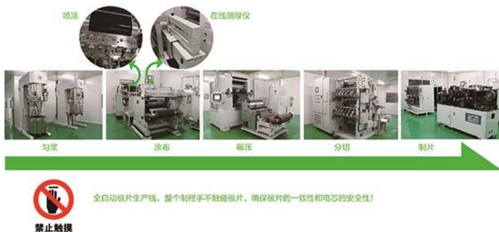
图 11: 宇量电池全自动化生产线
