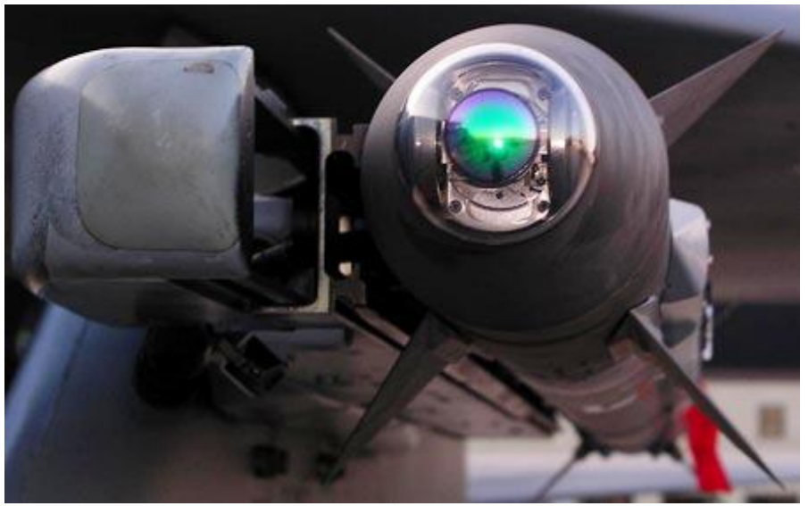
图表 11. 美军 AIM-9X 格斗弹红外导引头
