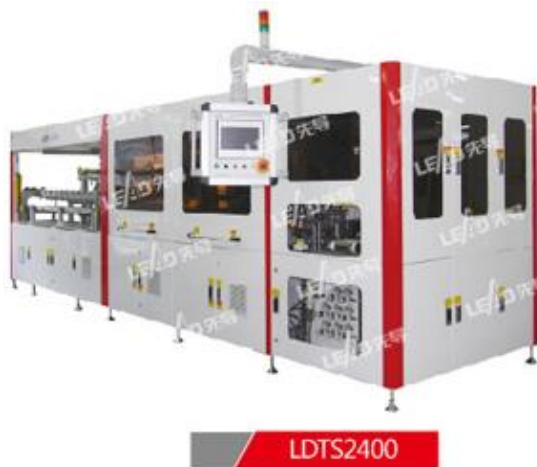
图 6：公司光伏生产设备：电池片高速串焊机
