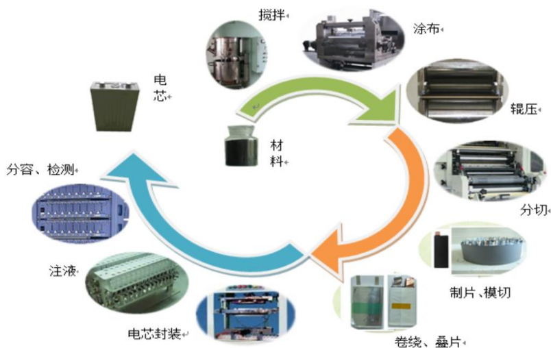
图 13: 锂离子电池生产工艺
