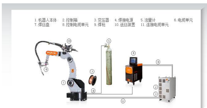
图 7：多功能数字化焊机系统构成
