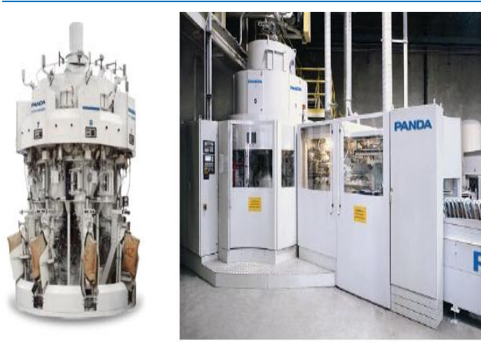
图 10：全自动颗粒状物体灌装机
