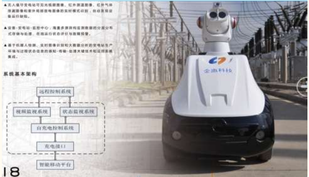
图表 7: 变电站智能巡检机器人
