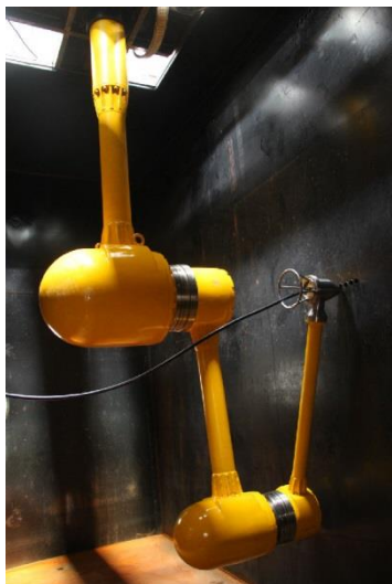
图 2: 公司产品: 凝汽器高压水射流在线清洗机器人
