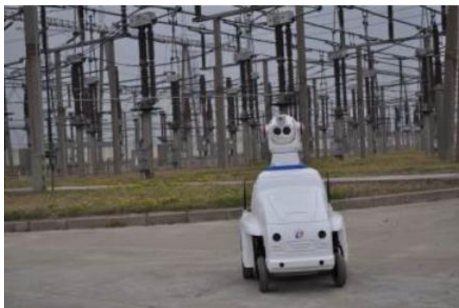
图 10：变电站智能巡检机器人
