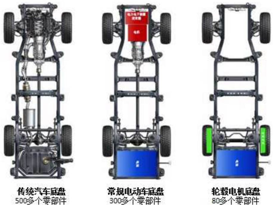
图表 15：传统汽车、常规电动车与轮毂电机底盘结构对比
