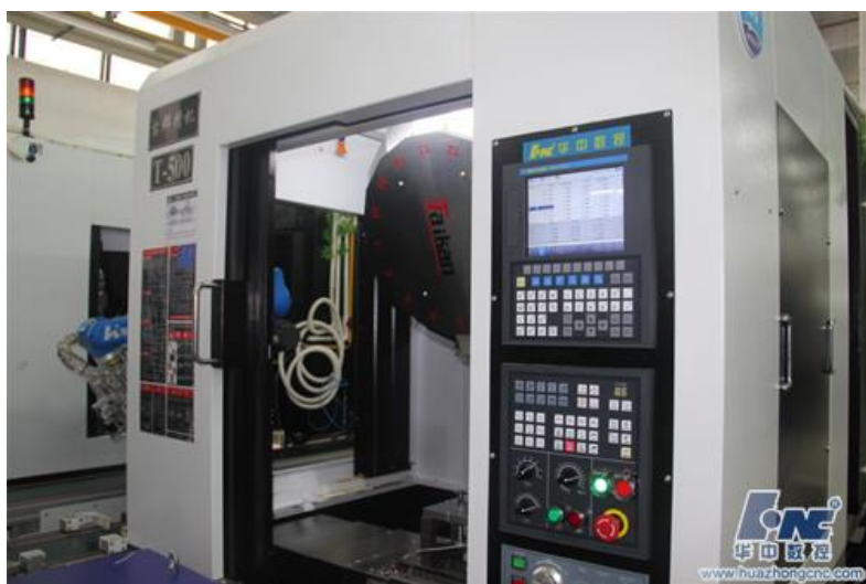
图 4：配套华中 8 型高档数控系统的高速钻攻中心
