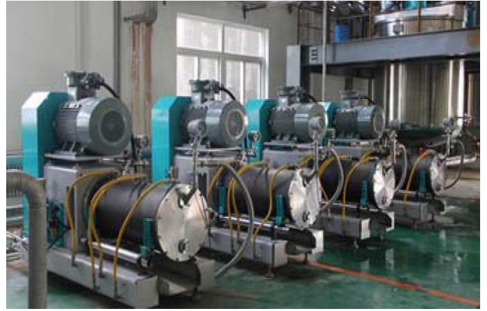
图 5：防腐油漆全自动生产线
