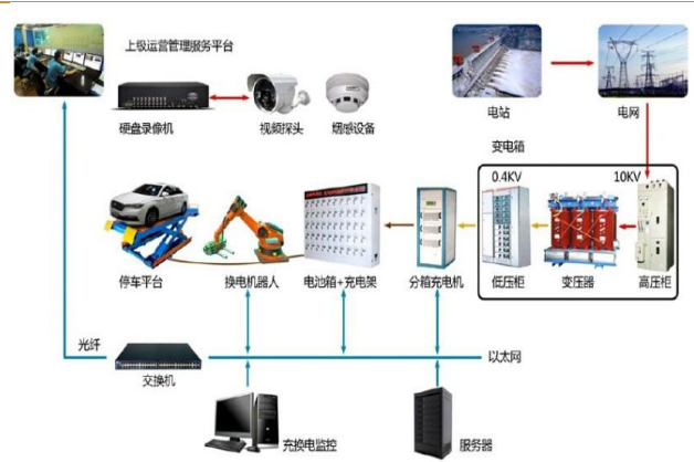
图 11: 力帆能源站结构图
