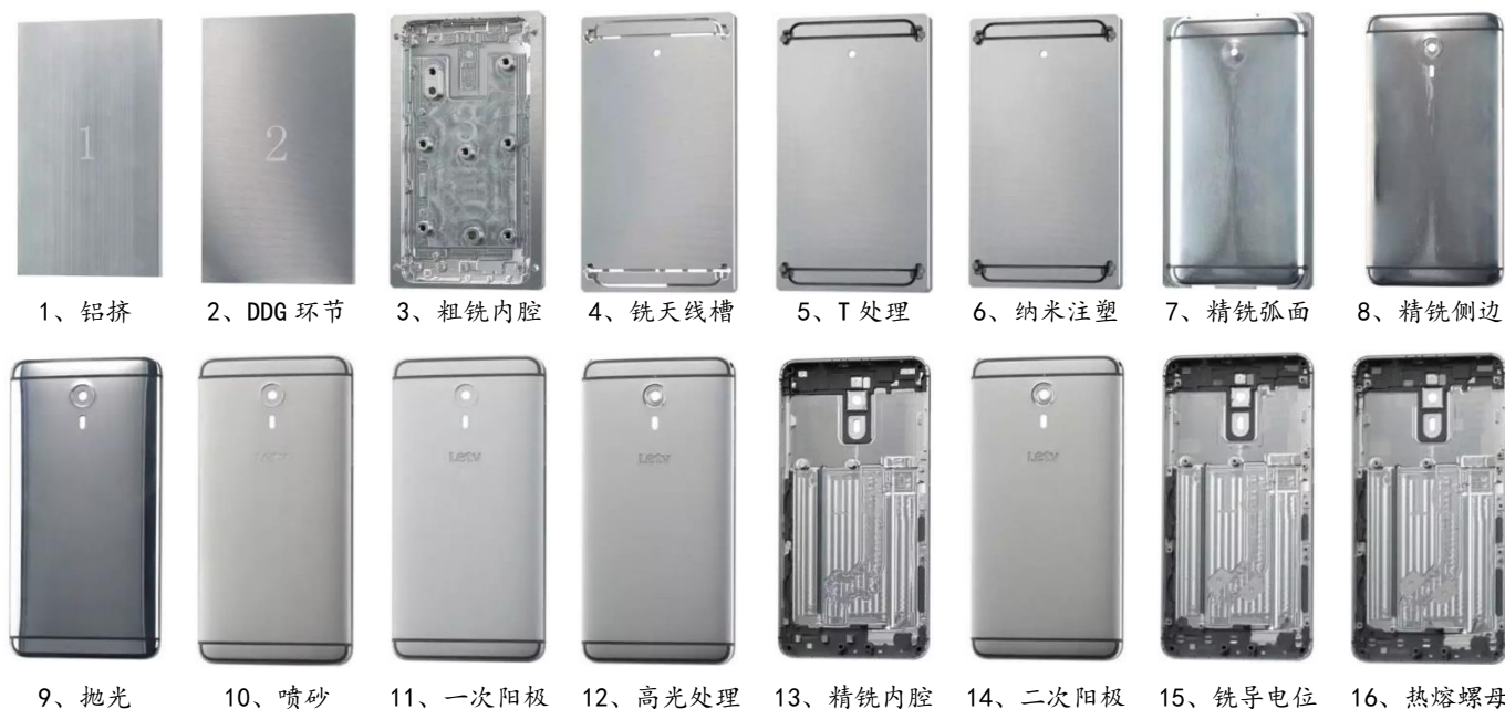
图表 9：乐视乐 Max 手机金属机身生产工艺
