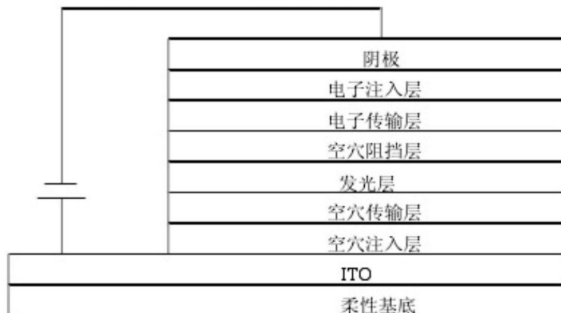
图表15 多层结构 OLED 结构示意图
