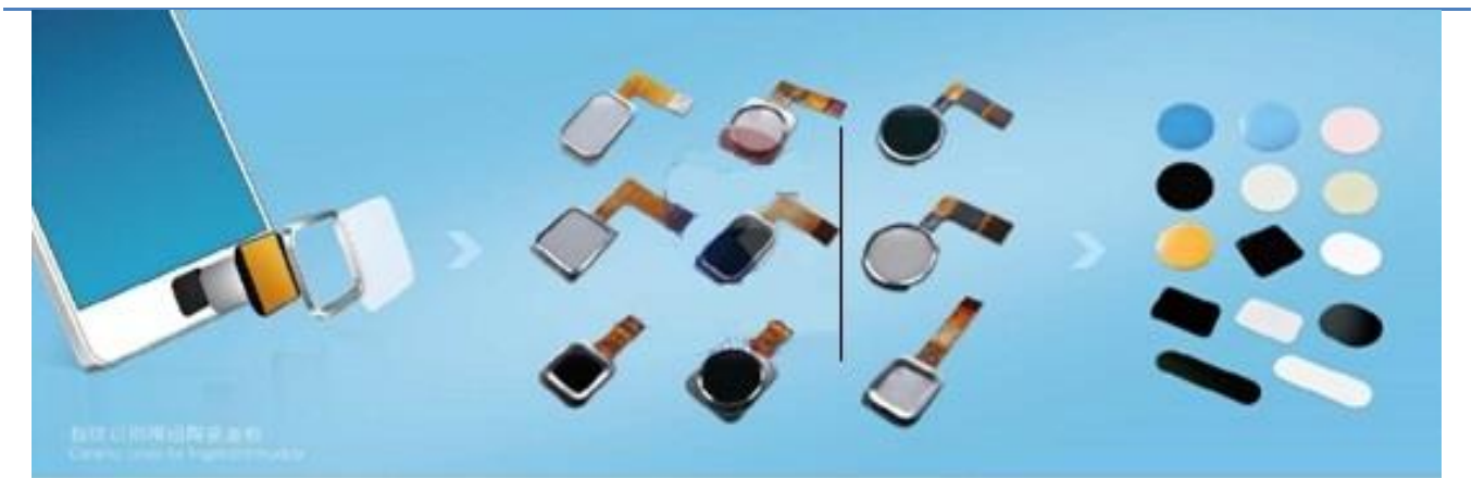
图 21：指纹识别模组中的陶瓷盖板（氧化锆）
