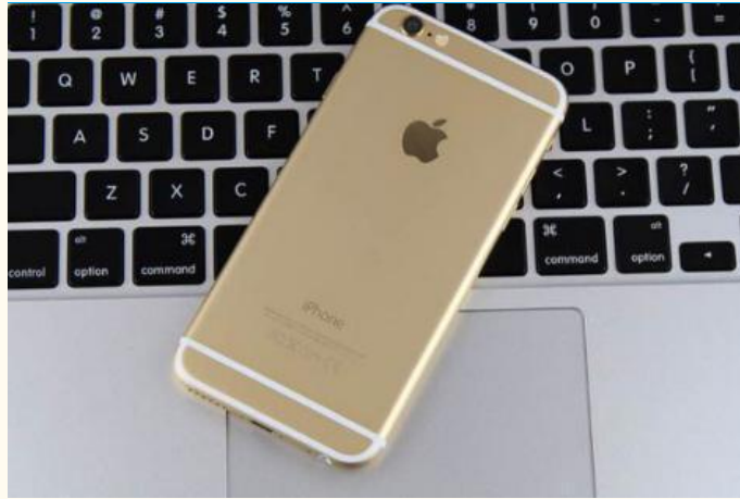
图表 28: Iphone 金属后盖开槽设计 (解决信号干扰问题)
