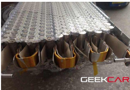
图 46 Tesla Model S 电池组拆解: 热管理系统内部构造
