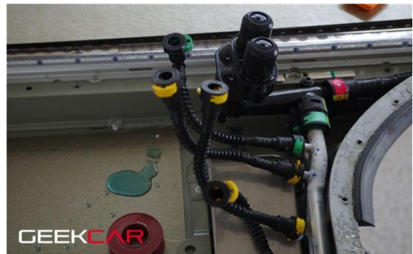
图 47 Tesla Model S 电池组拆解: 冷却液接口
