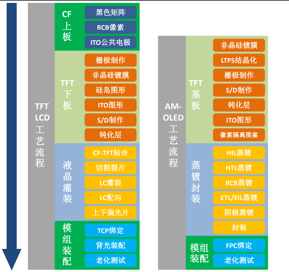
图表 20 TFT-LCD 及 LTPS AMOLED 面板工艺流程
