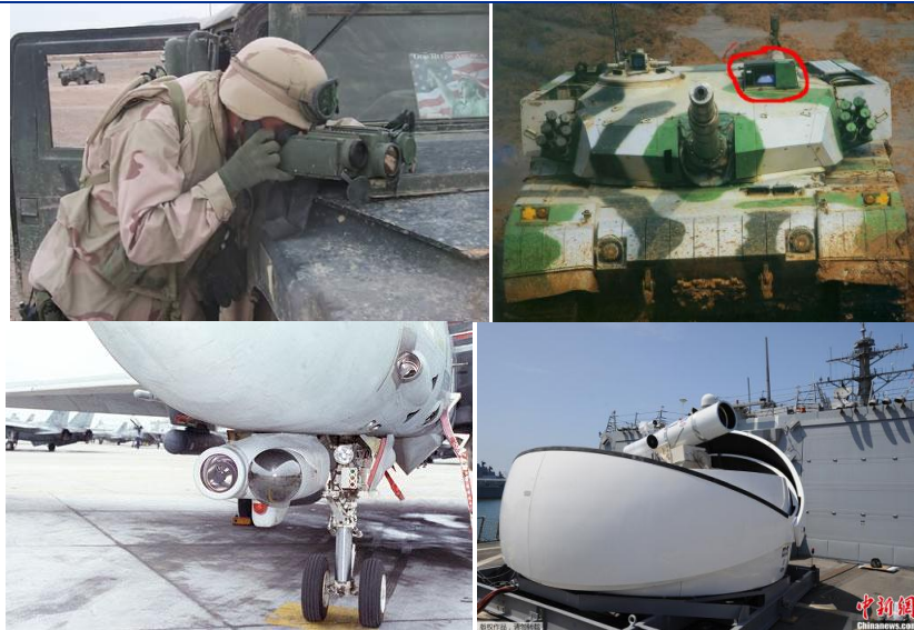
图 13: 激光测距仪在军事上的应用 (从左至右依次, 从上到下依次为: 单兵侦察用的手持式激光测距仪、坦克火控系统用激光测距仪、机载拦截用激光测距仪、舰载用火控和对空防御激光测距仪)
