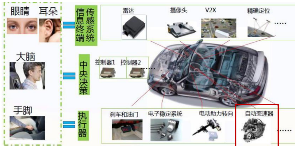
图 5: 自动变速器是智能驾驶执行层核心部件
