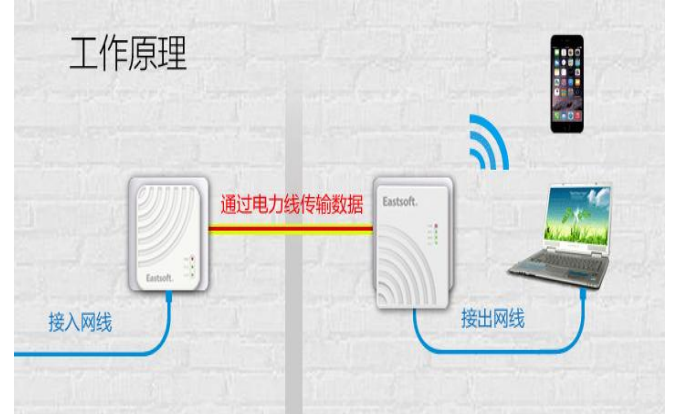
图 15：电力猫工作原理
