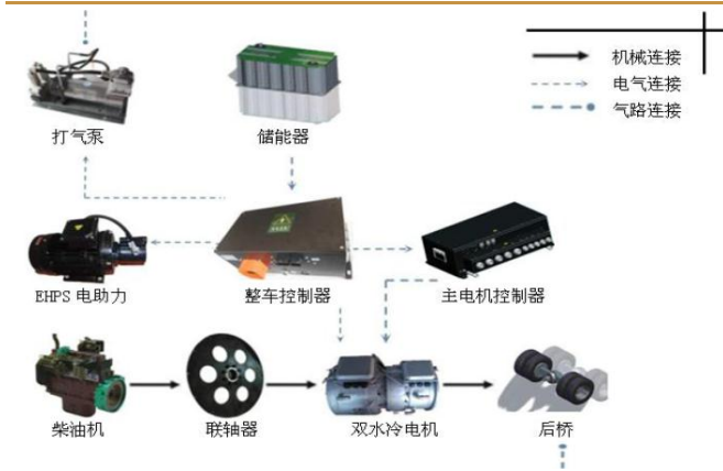
图 6：万润插电式混合动力连接图
