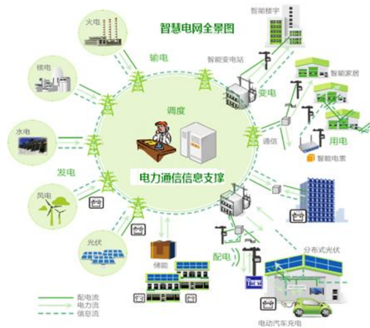
图表 37：智能微网光储充一体化
