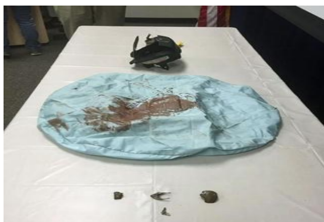
图 5：高田安全气囊测试后弹出的金属碎片
