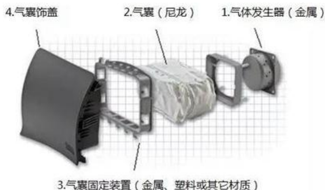
图 3：安全气囊组成
