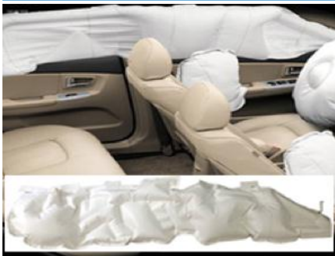
图 15：一次成型气囊袋（OPW）
