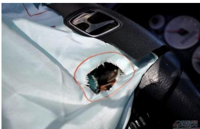
图 4：装车高田气囊事故弹出后形成的破洞
