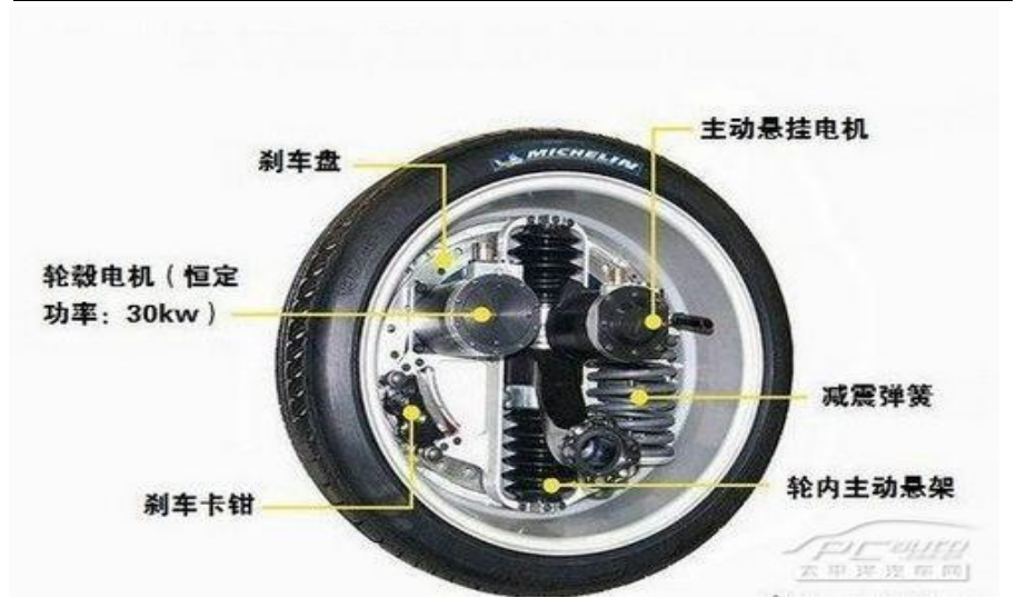
圖表 14. 輪轂電機結構示意圖
