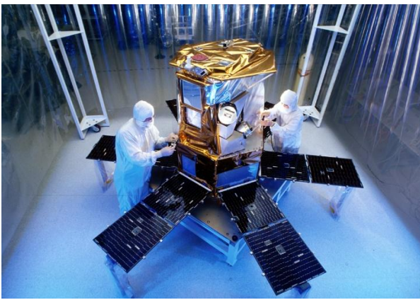
图表 26 人造卫星在洁净室中进行制造检测
