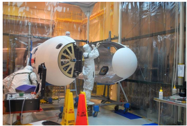
图表 27 “天马座” 航天飞机在洁净室中组装
