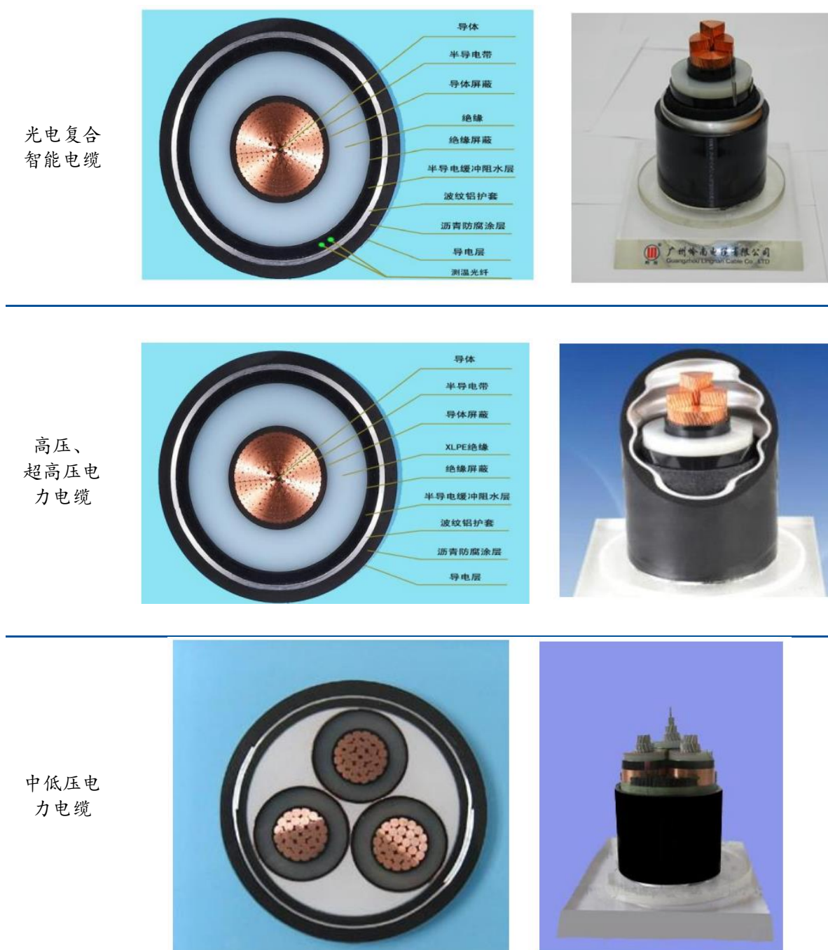
图 18：公司电缆产品基本结构图
