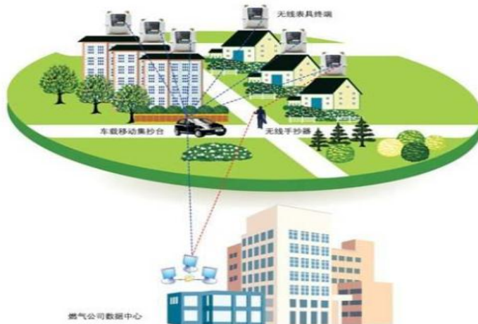
图 9：公司远程抄表系统流程
