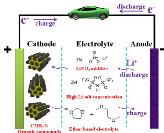
图 12: 锂电池电解液充放电过程
