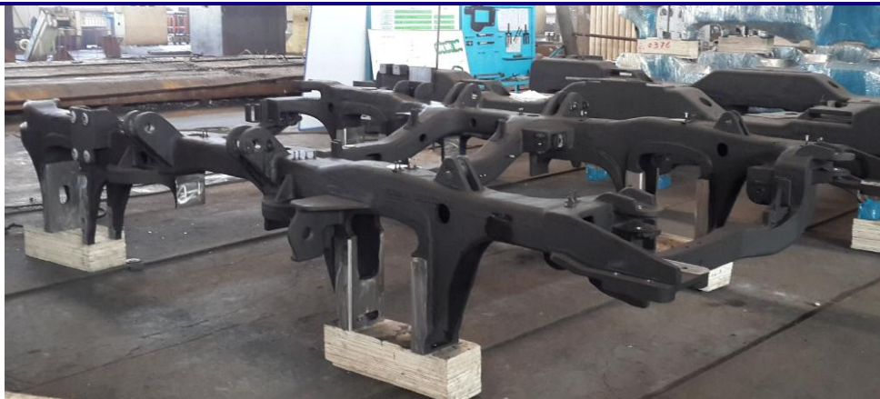
图 5: 公司出口澳大利亚的客运机车 CS 转向架
