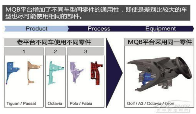
图 13: MQB 平台标准化零部件降低成本
