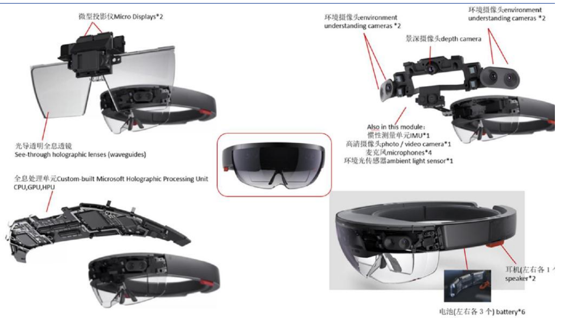
图 33: HoloLens 拆解图
