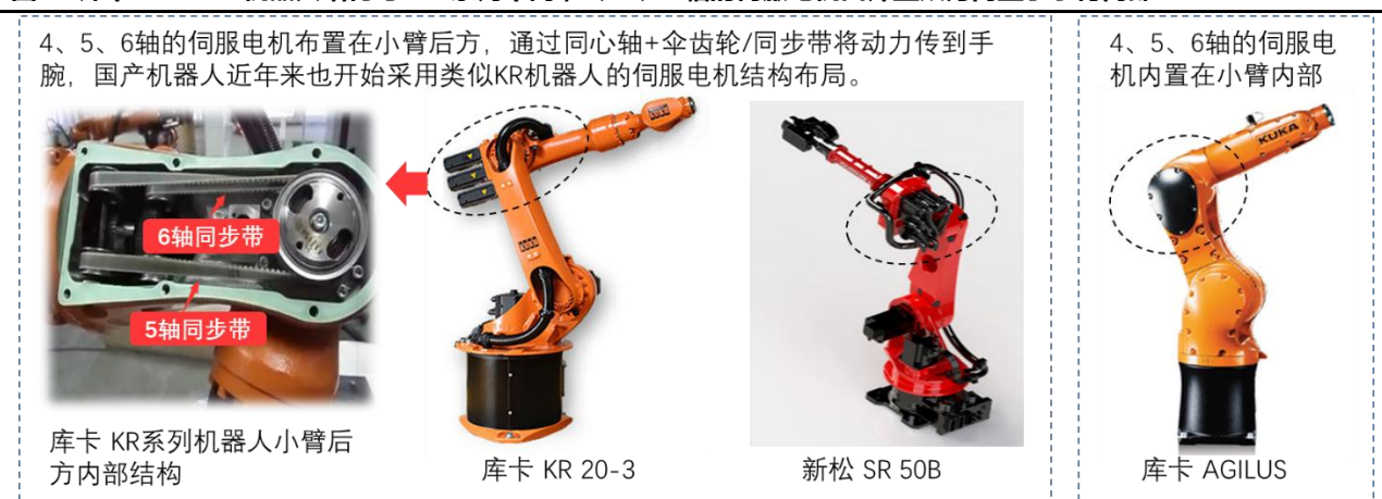
图 28 库卡 AGILUS 机器人结构与 KR 系列不同，4、5、6 轴的伺服电机由外置改为内置于小臂内部
