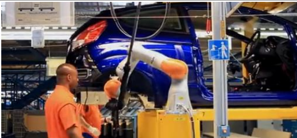
图 27 库卡 iiwa 机器人在福特汽车装配生产线上实现人机协作
