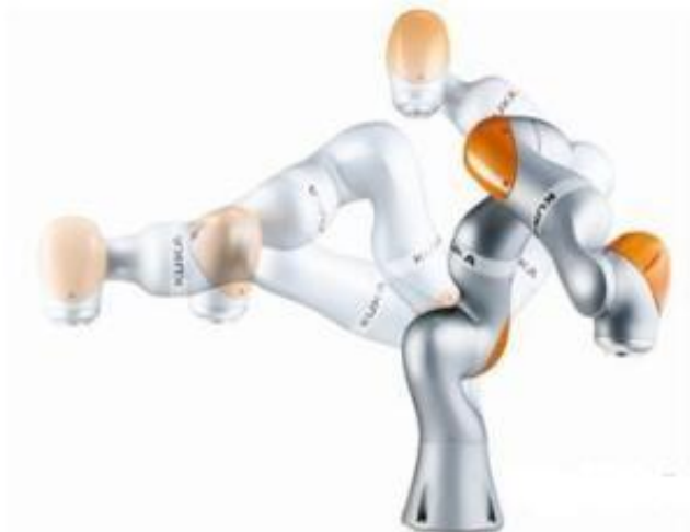
图 25 库卡 iiwa 七轴机器人重复精度可达 \pm 0.15\text{ mm}
