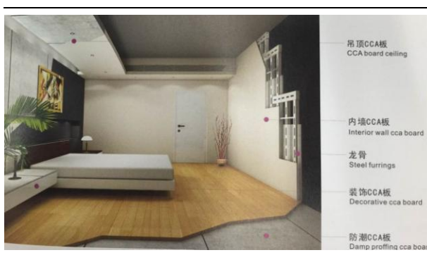
图表 11: 钢构住宅内部构造图
